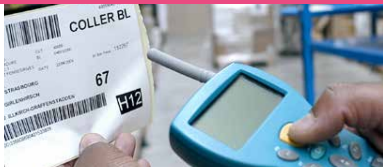
Neustrezno nameščena ali slabo oblikovana črna koda predstavlja motnjo pri identifikaciji izdelka s pomočjo skeniranja
