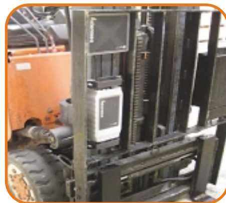
Čitalnik in antena za kode EPC/RFID sta nameščena na naslonu viličarja.
