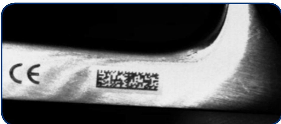
Slika 1: Označitev z UDI neposredno na medicinskih instrumentih
