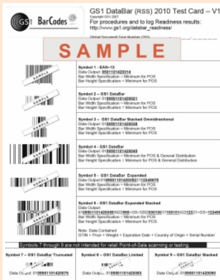
Slika: Primer testne kartice za kontrolo čitalnikov
